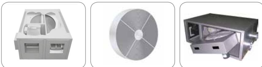
Gli apparecchi della serie **ROTO** sono unità ventilanti doppio flusso, equipaggiate con scambiatori di calore rotanti con efficienza media del **72%** in temperatura e **63%** in umidità. Questi rotori infatti sono rivestiti con materiale adsorbente (silica gel) che permette di trasferire non solo temperatura, ma anche umidità tra i due flussi d'aria. Le prestazioni dei rotori sono certificate da Eurovent. Versioni con moto-ventilatori AC o EC.
