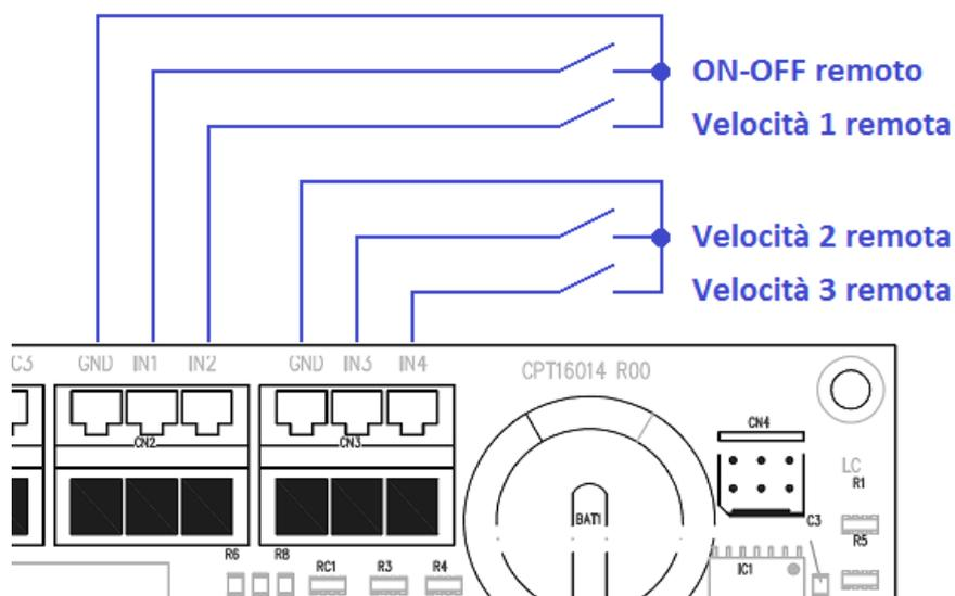
Figura 11 - Collegamento contatti puliti di on-off remoto e di velocità 1, 2 e 3 remota
