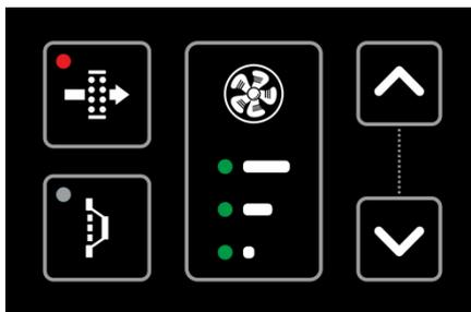
Figura 16 - il led rosso (in alto a sinistra) si accende per avvisare che è necessario verificare/sostituire i filtri
