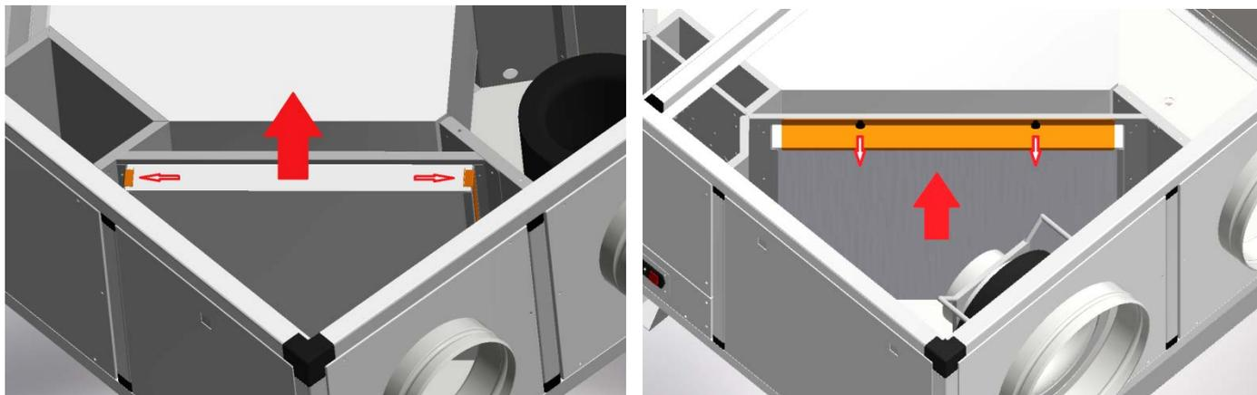
Figura 17 – Sequenza operazioni per rimuovere i filtri nelle unità di taglia piccola: dopo aver spostato (immagine a sinistra) o rimosso (immagine a destra) i fermi filtro, sfilare i filtri dalle guide.
