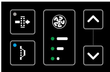
Figura 14 - il led blu (in basso a sinistra) si accende in modo fisso quando il free-cooling è attivo
