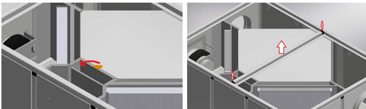
Figura 19 – Prima di rimuovere lo scambiatore di calore è necessario ruotare il fermo di sicurezza (nelle 2 taglie più piccole, immagine a sinistra) oppure togliere il profilo di alluminio tra i 2 coperchi, svitando le 2 viti alle estremità (nelle altre taglie, immagine a destra)
