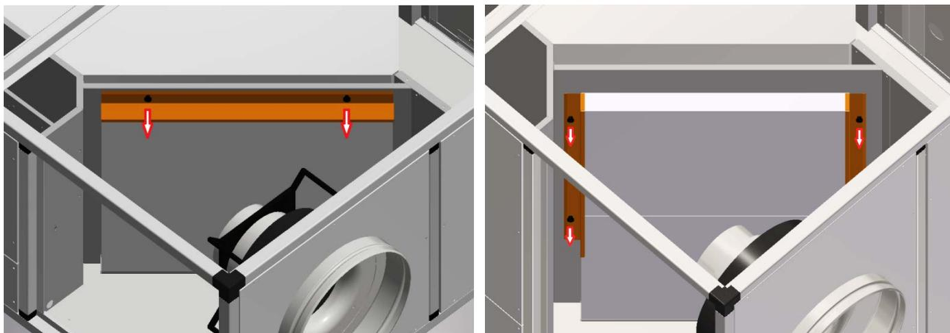
Figura 18 – Sequenza operazioni per rimuovere i filtri nelle unità di taglia grande: togliere i fermi filtro (dopo aver svitato le relative viti/pomelli di fissaggio) e estrarre i filtri dal coperchio frontale o dai pannelli laterali.
