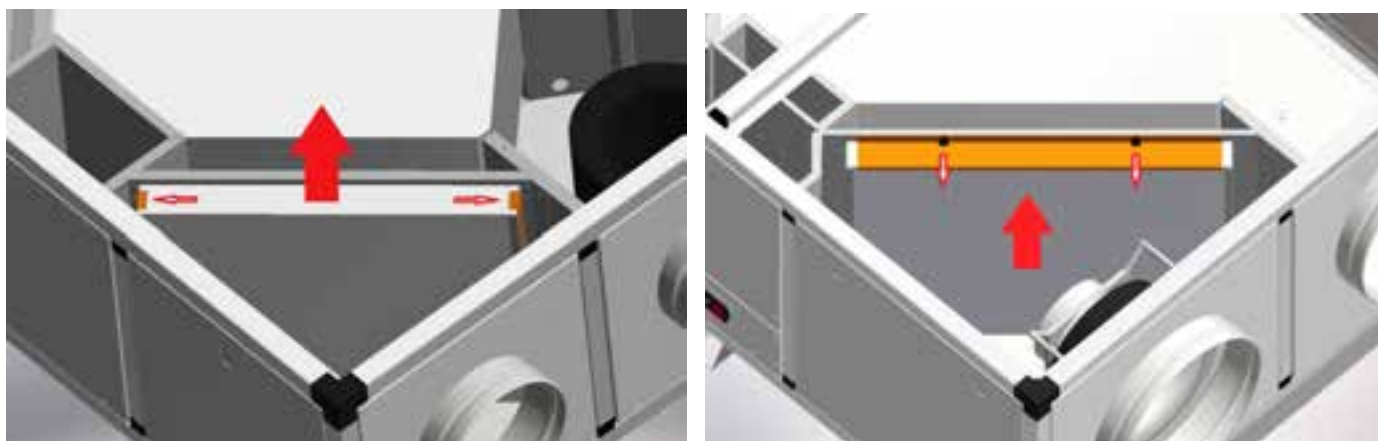
Figura 14 – Sequenza operazioni per rimuovere i filtri nelle unità di taglia piccola: dopo aver spostato (immagine a sinistra) o rimosso (immagine a destra) i fermi filtro, sfilare i filtri dalle guide.
