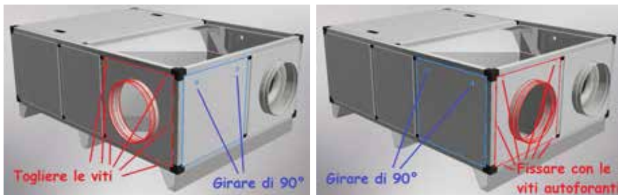
Figura 7 - Modifica orientamento attacchi
