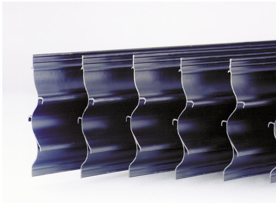
I profili dei separatori di gocce DH™ 4200, quando assemblati in unità, costringono il flusso d'aria sovrassatura a muoversi lungo una particolare traiettoria; grazie al profilo aerodinamico, la separazione delle gocce avviene con alta efficienza e basse perdite di carico.
