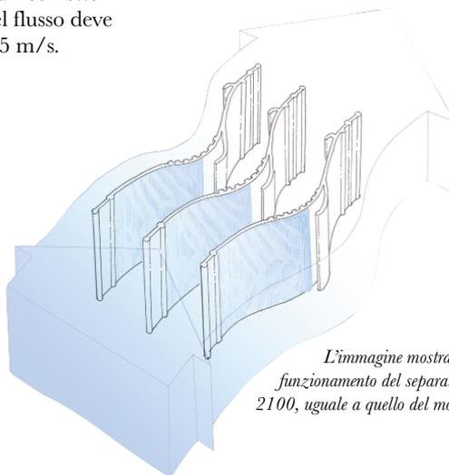
*L'immagine mostra il principio di funzionamento del separatore di gocce DH 2100, uguale a quello del modello DH 2500.*
