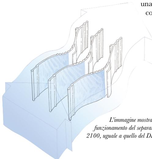
*L'immagine mostra il principio di funzionamento del separatore di gocce DH 2100, uguale a quello del DH 4200.*
