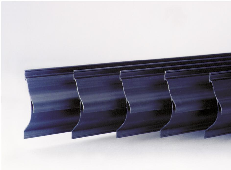
I profili dei separatori di gocce DH™ 2500, quando assemblati in unità, costringono il flusso d'aria sovrassatura a muoversi lungo una particolare traiettoria; grazie al profilo aerodinamico, la separazione delle gocce avviene con alta efficienza e basse perdite di carico.
