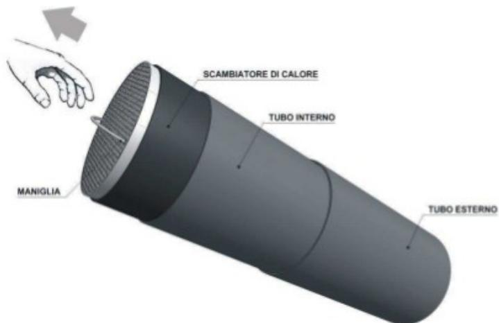
Fig.2 Estrazione scambiatore
