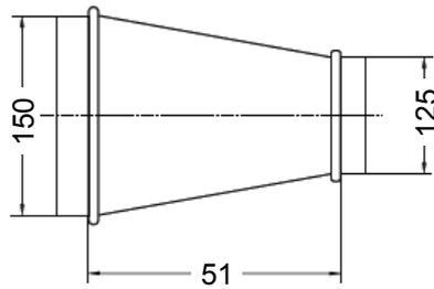
*PRO 150-125 Riduzione 150-125 per collegamento plenum ROZZ EPP con tubi diam.. 150 mm.*
