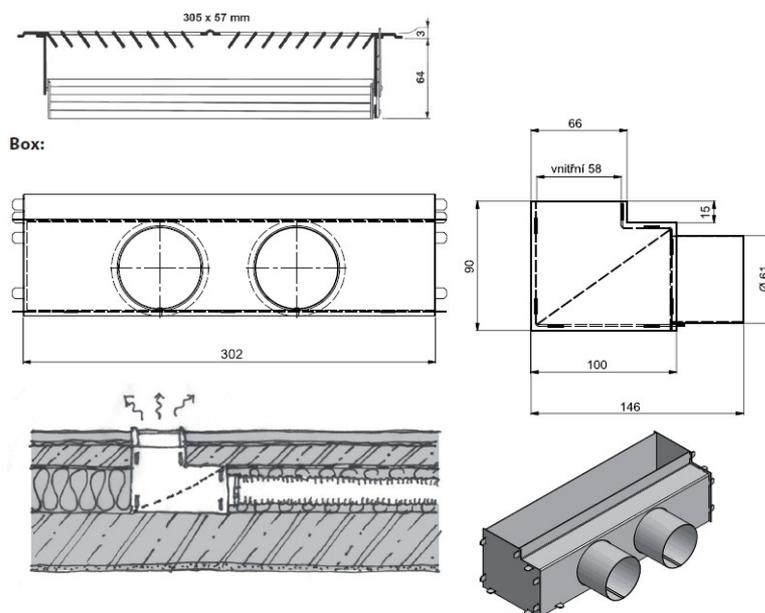
*ROZ-PB-2P I kit di mandata lineare regolabile con plenum da incasso per arrivo tubi a 90°, possono essere collegati a 1 o 2 tubi Duotec (per una minore o maggiore portata d'aria). Colore RAL9010*
