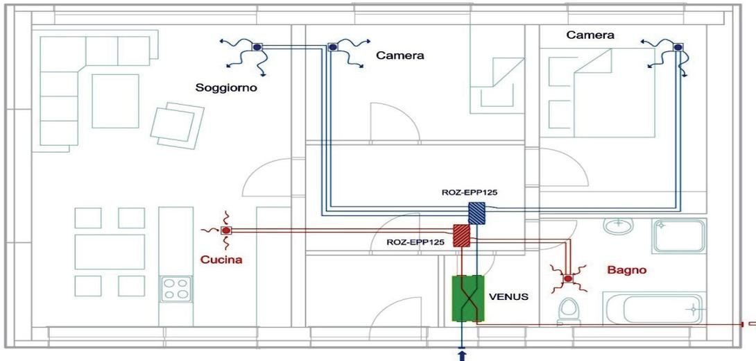
*Esempio di impianto di ventilazione con recupero di calore per unità abitativa monofamiliare*
