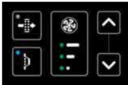
Figura 8 - il led blu (in basso a sinistra) si accende in modo fisso quando il free-cooling è attivo
