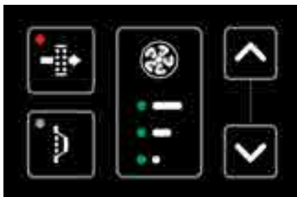
Figura 10 - il led rosso (in alto a sinistra) si accende per avvisare che è necessario verificare/sostituire i filtri
