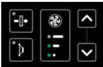
Figura 7 – in questa immagine si vedono i 2 led verdi accesi, quindi è attiva la velocità 2
