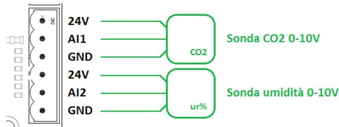
Figura 7 – Collegamento sonde umidità e qualità aria 0-10V
