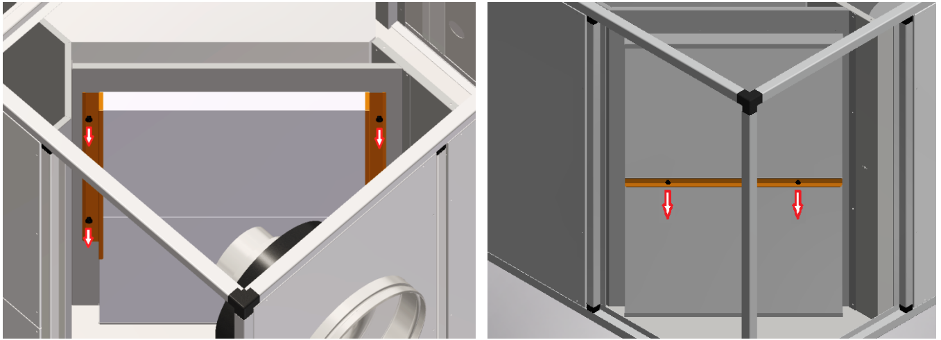
Figura 9 – Sequenza operazioni per rimuovere i filtri nelle unità di taglia grande: togliere i fermi filtro (dopo aver svitato le relative viti/pomelli di fissaggio) e estrarre i filtri dal coperchio frontale o dai pannelli laterali.
