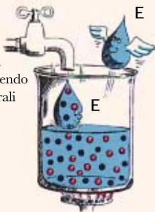
Per evitare l'accumulo di minerali insolubili sulla superficie del pannello (incrostazione) che possono causare una maggiore perdita di carico, una certa quantità di acqua di ricircolo deve essere scaricata e sostituita con acqua di rete. L'acqua eliminata viene chiamata Bleed-off B.
