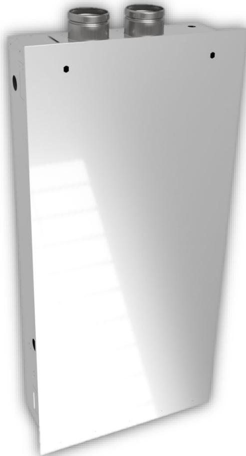
**Telaio da incasso per unità di ventilazione, struttura autoportante in lamiera zincata, isolamento termico/acustico in polietilene espanso sp. 10mm**
