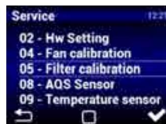
Si deve sempre eseguire la calibrazione al primo avvio ed ogni volta che si sostituisce il filtro.
