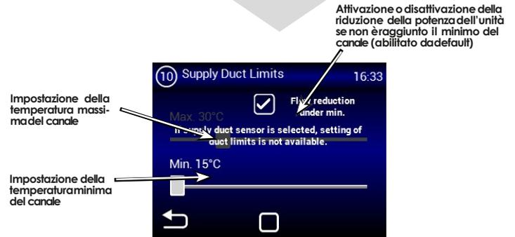
Si raccomanda di lasciare attiva la diminuzione del flusso della portata se non viene raggiunta il minimo del canale per ovviare la formazione di condensa sulla superficie della tubazione HVAC.
